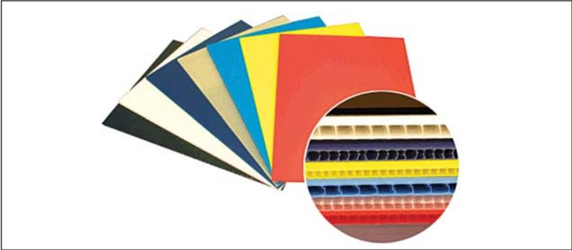
**Figura 2.6:** Imagem de placas de plástico corrugado com destaque para as ranhuras que unem as faces do plástico (Kayserberg, 2012).
