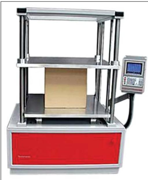
Na **Figura 4.18**, é apresentada uma foto de um ensaio de resistência à compressão.
