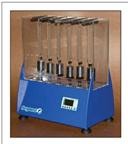
**Figura 4.10:** Equipamento para determinação de descolamento de onda da empresa Regmed. (Regmed, 2012).
