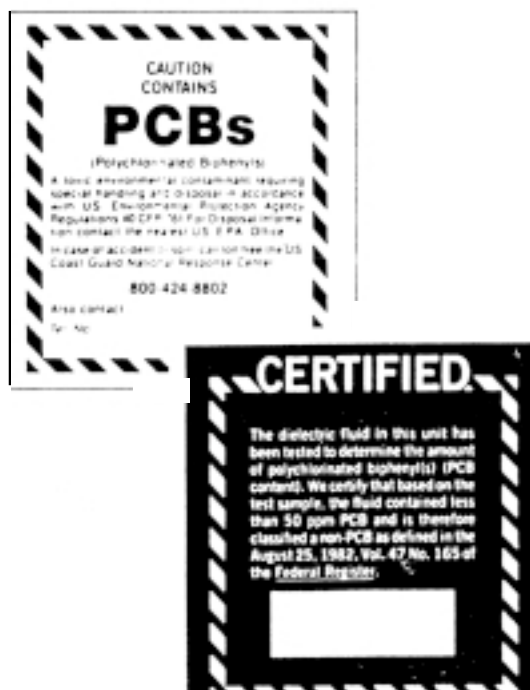
Figura 2. Exemplos de sinalização de PCB
